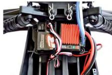
2,4 GHz und ein programmierbarer Fahrtregler für Brushed-Motoren ab 12 Turns sind zwei Highlights des Robitronic Smasher.
