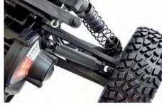
Die oberen Querlenker sind recht weich, was sie vor einem Brechen beim Crash schützt. Die Teleskop-Antriebswellen aus Kunststoff versprechen lange leichten Lauf.
