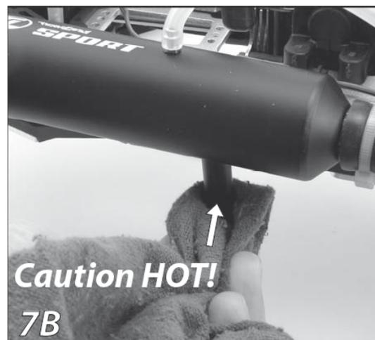
Nach der Fahrt können Sie den Motor abstellen, indem Sie die Pumpe am Tank mehrmals betätigen. Wenn der Motor trotzdem weiterläuft, haben Sie die Möglichkeit, mit dem Griff eines Schraubenziehers, oder mit einem Tuch den Auspuff zuzuhalten, um so den Motor abzustellen. Bitte hierbei besonders vorsichtig sein, da der Auspuff extrem heiß wird.
