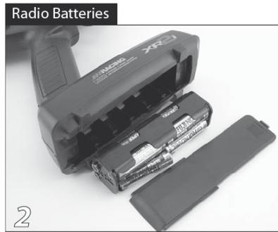
Geben Sie 8 Stück neue Batterien in den Batteriehalter des Senders. Vergewissern Sie sich das die Polarität (+/-) richtig ist. Verwenden Sie nur Trockenbatterien, oder Wiederaufladbare NiMH Akkus der Baugröße AA.
