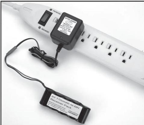
Laden Sie vor Inbetriebnahme den Akkupack mit dem Ladegerät auf. Während des Ladevorganges leuchtet die rote LED am Ladegerät auf. Die Ladezeit für Vollladung beträgt 12 Stunden.
