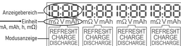
\*Zu Beginn eines Programms führt das Gerät immer einen schnellen Standardtest durch, um den Akku-Innenwiderstand zu ermitteln. Ältere Akkus oder Akkus in schlechtem Zustand haben einen höheren Innenwiderstand und erwärmen sich daher beim Laden oder Entladen stärker. Die Werte sind Schätzwerte und variieren je nach Zustand des Akkus und Betriebsumgebung.
