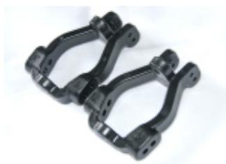
Mit den 6° Blöcken kann der Nachlauf noch weiter reduziert werden. In Verbindung mit dem Kick-Up des Chassis und der Hing-Pin Halter kann so ein Nachlauf von 12° erreicht werden.
