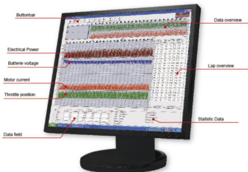
Mit PC-Interface und USB-Kabel können die Daten vom letzten gefahrenen Akku des Cube2 schnell auf jedem Laptop oder PC ausgelesen werden. Der Datenrecorder zeigt Ihnen alle relevanten Daten um die entscheidenden Zehntelsekunden zu finden. Die grafischen Darstellungen und die angezeigten Rundenzeiten helfen Ihnen, Ihren Fahrstil und die Einstellungen des Cube2 recht einfach zu optimieren. Die Software unterstützt die aktuellsten Windows Plattformen, wie Windows XP, Vista und 2000.
