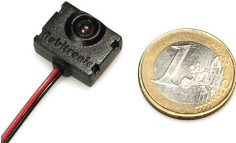
Mit dem extrem kleinen und leichten Transponder besitzt jedes Modellauto automatisch eine weltweit einzigartige Identifikationsnummer. Fährt ein so ausgestattetes Fahrzeug über die Start/Ziellinie, wird das Transpondersignal mit der Identifikationsnummer vom Empfängermodul in der Zeitnahmebrücke erkannt und ausgewertet.
