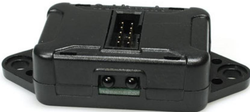
Das Empfangsmodul und der Transponder arbeiten mit Infrarotsensoren. Die Empfängermodule können, beliebig, durch einfaches Plug & Play, erweitert werden. So kann das System an jede Streckenbreite angepasst werden. Es sollte ca. alle 30cm ein Empfängermodul angebracht werden, im Randbereich sollte ein Abstand von ca. 15cm eingehalten werden.
