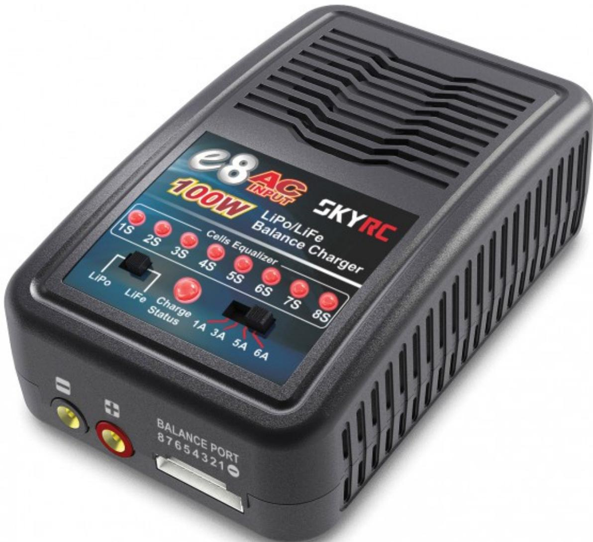
Der SKYRC e8 Lader ist ein kostengünstiger, aber dennoch hochwertiges 100-240V AC Ladegerät mit Balancer. Er lädt LiPo und LiFe Akkus mit bis zu 8 Zellen. Es stehen 100W maximale Ladeleistung zur Verfügung um bis zu 5A Ladestrom zu erzielen. Akkus können mit 1A/3A/5A oder 6A geladen werden, so kann entsprechend der Akkukapazität der richtige Ladestrom gewählt werden.
