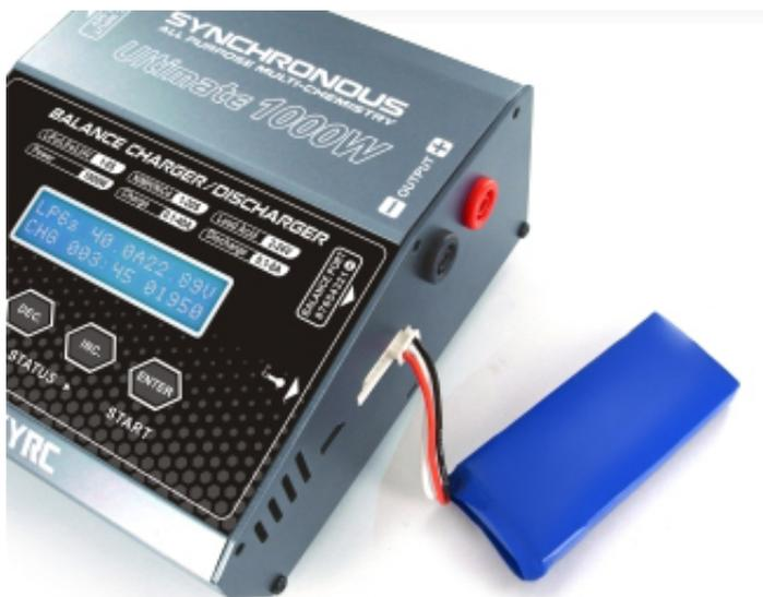
Einige kleinere Akkus besitzen keinen Hauptanschluss, diese können gleich über den Balancer Port geladen bzw. entladen werden.
