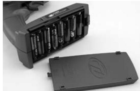
4. Entfernen Sie die Batterieabdeckung der Fernbedienung durch schieben in die auf der Abdeckung angegebene Richtung. Legen Sie 8 AA Batterien in das Batteriefach entsprechend der im Batteriefach abgebildeten Polarität ein. Setzen Sie die Batterieabdeckung wieder ein.
