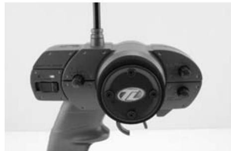
6. Schalten sie IMMER den Sender zuerst ein. Die rote und grüne Kontroll-LED über dem Schalter muss leuchten. Falls dies nicht der Fall ist, prüfen Sie bitte die Polarität bzw. Spannung der eingelegten Batterien
