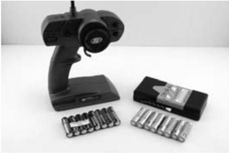
1. Ihr LOSI Micro Fahrzeugset inkludiert zwei komplette Sets Batterien. Setzen Sie die Heavy Duty Batterien mit der Aufschrift „Transmitter Use Only“ in die Fernbedienung ein.
