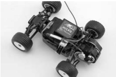
5. Nach erfolgter Ladung verbinden Sie das Fahrzeugakkukabel mit dem Fahrtenreglerkabel und setzen Sie die Karosserie auf das Fahrzeug auf. Sichern Sie diese mit den dafür vorgesehenen Karosserieklemmen.
