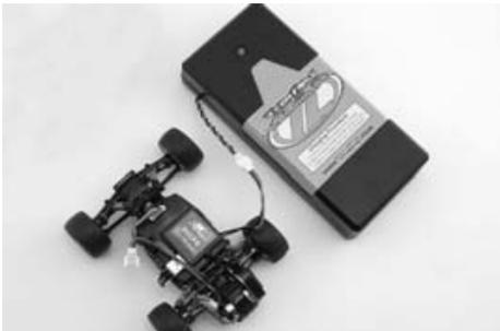
3. Verbinden Sie das Laderkabel mit dem Fahrzeugakkukabel. Die rote Kontroll-LED leuchtet während dem Ladevorgang auf. Die Kontroll-LED erlischt wenn der Fahrzeugakku vollständig geladen ist (nach ca. 20 Minuten). Leuchtet die Kontroll-LED nur ca. eine Minute auf, ersetzen Sie bitte die Batterien des Laders.
