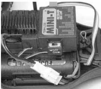
5. Setzen Sie die Batteriebox so ein, dass der Stecker sich an der rechten vorderen Ecke befindet. Schwenken Sie die Montageplatte mit der Empfänger / Fahrtenregler-Einheit über die Batterien auf die Haltestütze zurück. Sichern Sie sie wieder mit dem Halteclip. Stecken Sie den Stecker so in die Buchse ein, wie es durch die Führungen vorgegeben ist.
