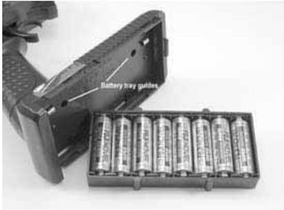
1. Entfernen Sie die Batterieabdeckung der Fernbedienung. Legen Sie 8 AA Batterien in das Batteriefach entsprechend der im Batteriefach abgebildeten Polarität ein. Setzen Sie die Batterieabdeckung wieder ein. Setzen Sie das Batteriefach entlang den Führungen wieder ein. Schließen Sie die Batterieabdeckung.
