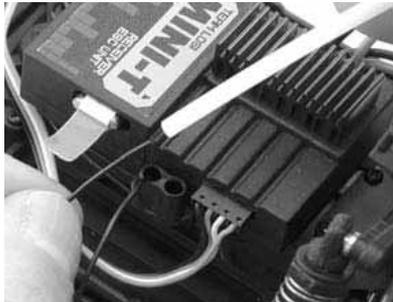
3. Fädeln Sie das Antennenkabel durch das Antennenrohr, bis dieses am anderen Ende wieder herauskommt. Setzen Sie das Antennenrohr fest in die Antennenhalterung ein.
