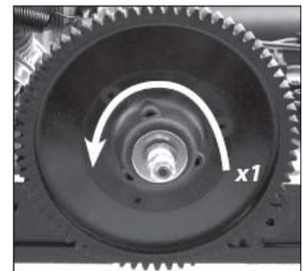
einem Steckschlüssel. Ein verdrehen der Einstellmutter im Uhrzeigersinn (nach rechts) bewirkt einen reduzierten Slip d.h. die Kraftübertragung erfolgt direkter, ein verdrehen der Einstellmutter entgegen den Uhrzeigersinn (nach links) bewirkt einen erhöhten Slip d.h. die Kraftübertragung erfolgt indirekter. Zur Grundeinstellung drehen Sie die Einstellmutter ganz hinein, und drehen Sie danach die Einstellmutter wieder eine Umdrehung gegen den Uhrzeigersinn heraus.
