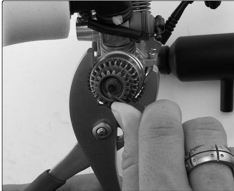
Kugellager in die neue Kupplungsglocke ein. Bevor Sie die Kupplungsglocke einbauen wischen Sie Innenseite mit Motorspray oder einem ähnlichen Reiniger aus. Verwenden Sie keinen Benzin- oder Ölbasierende Reiniger bzw. Lösungsmittel). Bauen Sie die Kupplungsglocke und sichern Sie diese mit der Halteschraube. Ziehen Sie die Schraube nicht zu fest an. Achten Sie darauf, dasselbe Drehmoment einzuhalten, das zum Entfernen verwendet wurde.
