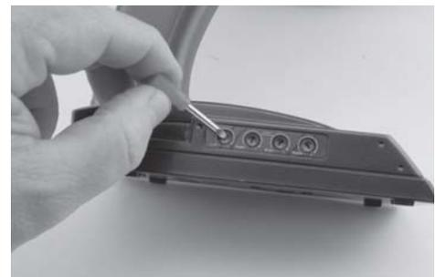
Für eine korrekte Einstellung drehen Sie den Einstellregler nach rechts und links um den Punkt zu finden, an dem sich die Vorderräder nicht mehr weiter nach rechts bewegen. Wiederholen Sie den Vorgang mit dem Steuerrad nach links und dem Einstellregler mit der „left“ Markierung.
