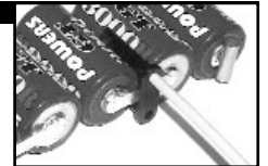
Montage des Temperaturfühlers
